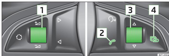
Отдельными пунктами меню Телефон на дисплее MAXI DOT можно управлять с помощью клавиш и регуляторов на многофункциональном рулевом колесе.
