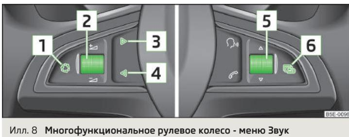
Отдельные меню и пункты меню, представляемые на дисплее MAXI DOT, можно выбирать с помощью клавиш на подрулевом переключателе следующим образом:
