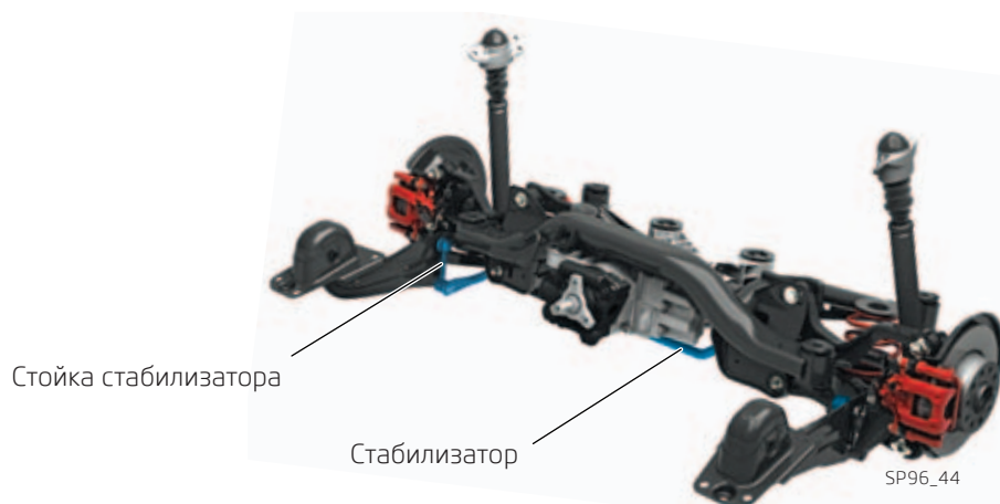
Многорычажная задняя подвеска автомобиля ŠKODA Octavia II 4x4 (стабилизатор со стойками выделен синим цветом)
