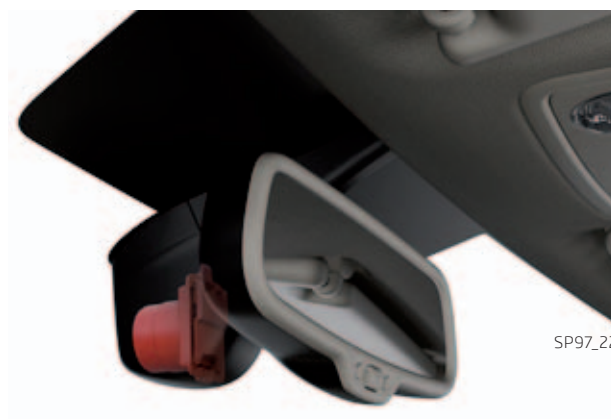
Отдельная камера ассистента управления дальним светом
