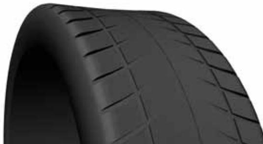
Износ шины при высоком давлении
