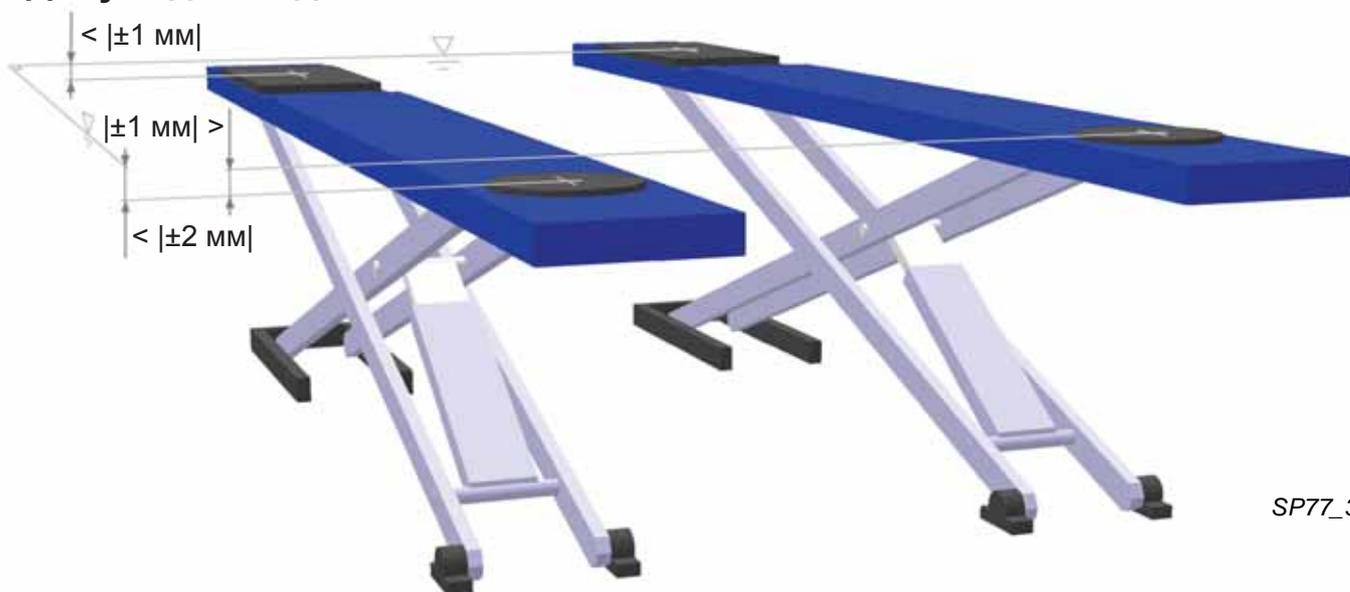
При проверке геометрических параметров подъёмных приспособлений применяются более высокие требования к точности, по сравнению с обычными подъёмниками.
